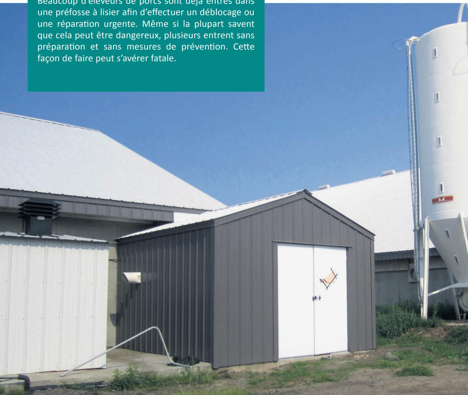
Les gaz produits dans le lisier en sortent progressivement et ils peuvent s'accumuler dans les préfosses et les locaux. Ici, il s'agit du local de la préfosse.
