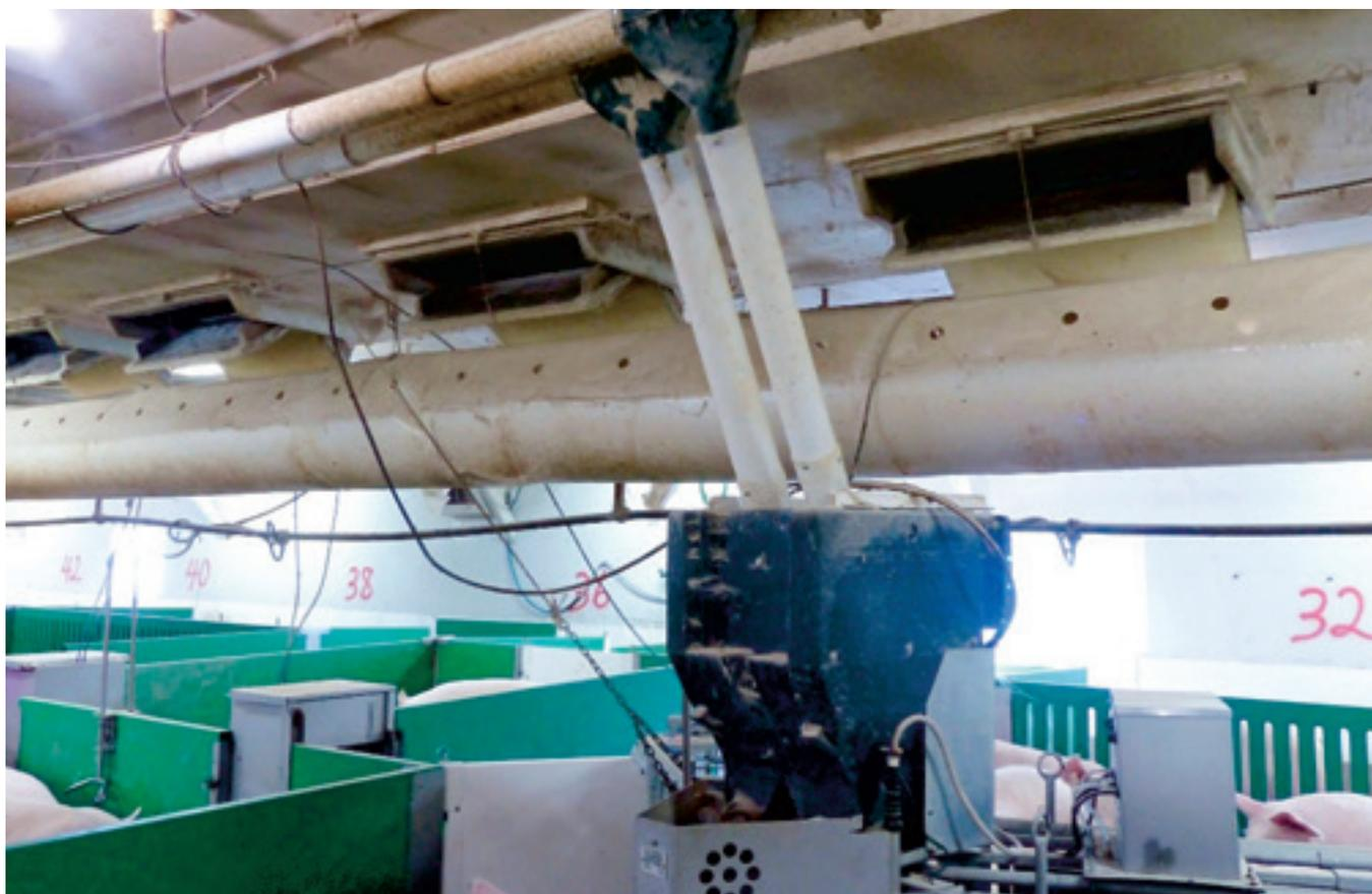
Photo 1 : Deux lignes de soigneurs installées dans l'entreprise Hog Tied Farms en Ontario, permettant la distribution de deux aliments différents en simultanée.
